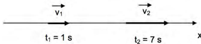
Dans ce cas l'accélération est positive, dans le même sens que l'axe  $x$ . Il s'agit d'un mouvement rectiligne accéléré.
